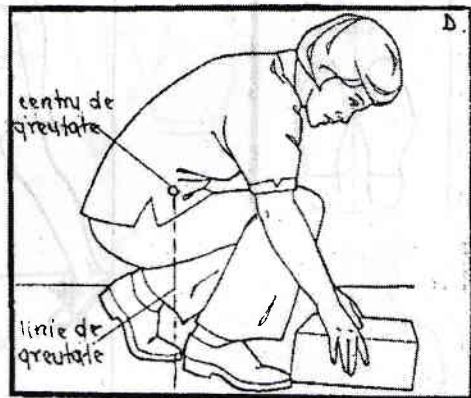
Fig. 2 A – Influența centrului de gravitație
